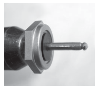
Adattatore per rivettatrice
