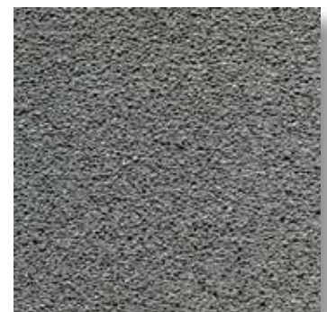
FOAMGLAS®: Millionen hermetisch geschlossene Glazellen.
