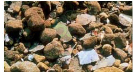
Grabenfüllmaterial aus zerkleinertem FOAMGLAS®
