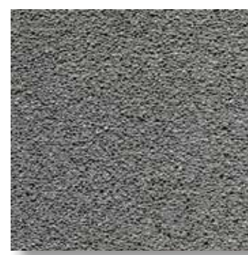
FOAMGLAS®: Millionen hermetisch geschlossene Glaszellen.
