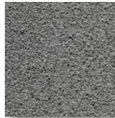
FOAMGLAS® besteht aus geschäumtem Glas und ist erhältlich als Platten oder Boards
