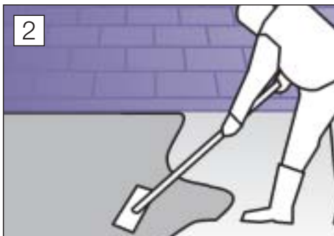
2 Verlegung in nicht abgebundendem Frischbeton
