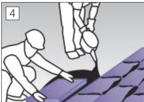
4 Verlegung mit Heißbitumen
