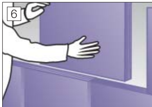
6 Kraftschlüssige Verklebung zum Untergrund
